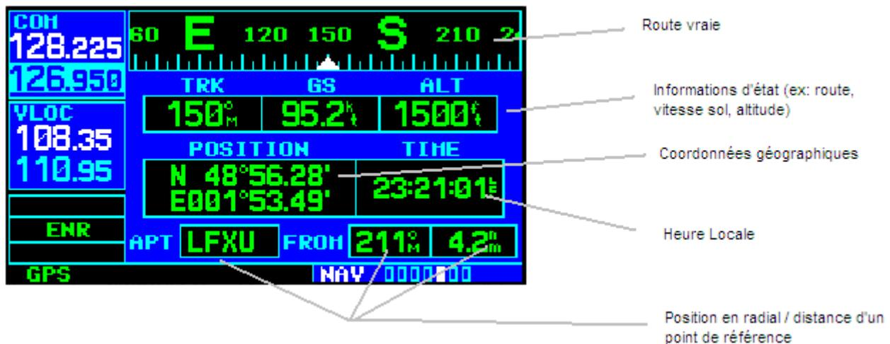
*Remarque: l'heure affichée par le GPS est l'heure la plus exacte qui soit. Elle provient d'une horloge atomique embarquée dans les satellites de la constellation GPS.*
