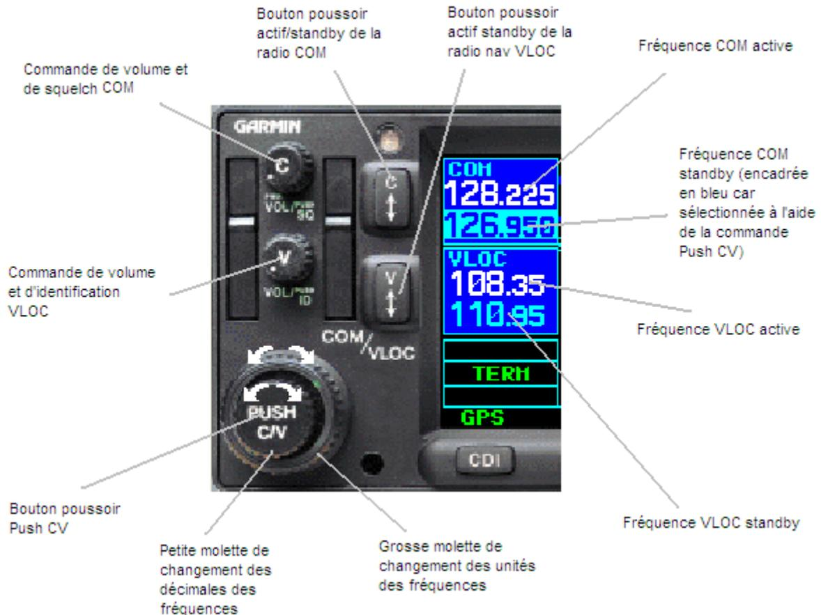
Les commandes radio sont les mêmes que pour les autres types de radio. Les fréquences radio et VLOC sont affichées en colonne sur la partie gauche de l'écran avec de haut en bas: COM actif, COM standby, VLOC actif, VLOC standby.
