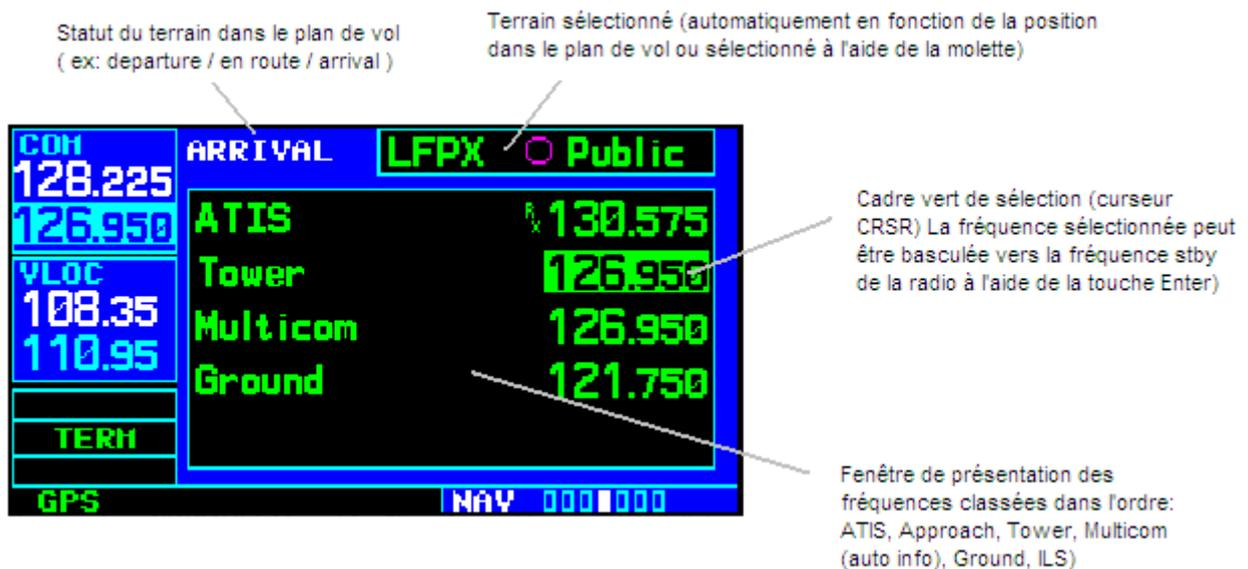
*Remarque: en page COM/NAV, si aucun plan de vol n'est actif, le GNS sélectionne le terrain le plus proche de la position d'initialisation du GPS.*
